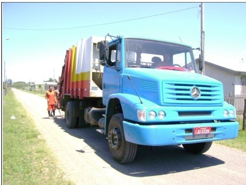
**Figura 2 - Caminhão usado na coleta de RSU.**
